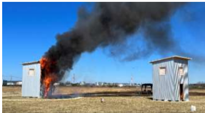
不燃処理なし棟
