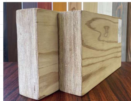
1時間耐火被覆層（耐火構造部）のサンプル。国産スギLVL
