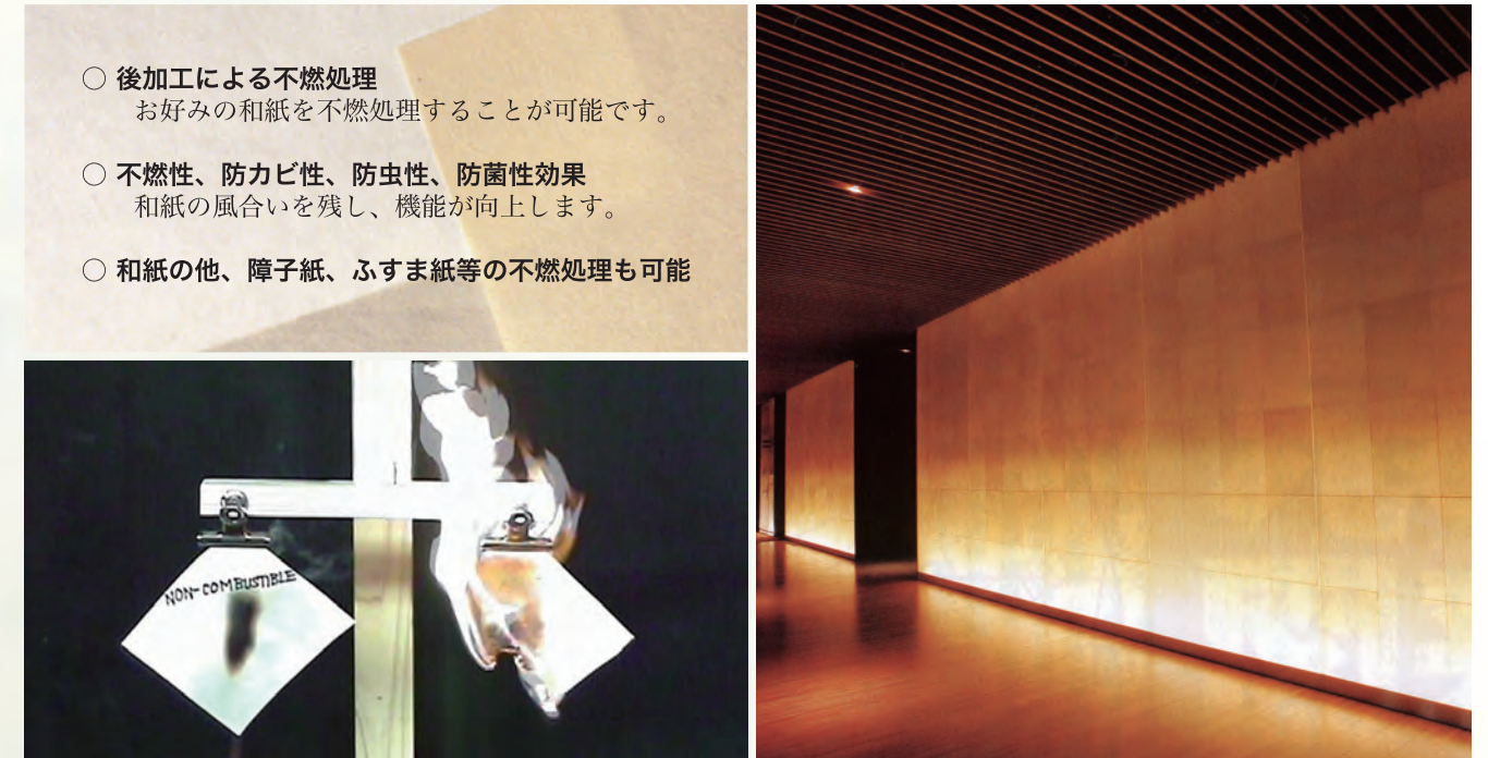
不燃和紙の燃焼実験 (左: セルフネン液含浸処理、右: 処理なし) サントリー美術館 (東京ミッドタウン / 2006)
