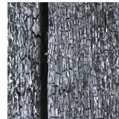
1時間1,000℃での耐火性能試験後の外部表面材の耐火LVL。表面が炭化している。
