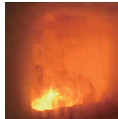
耐火性能試験中の炉内。炉内温度は1,000℃で赤くなっているのは外部表面材の耐火LVL。
